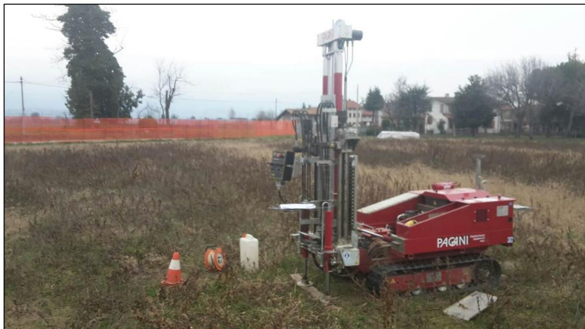
*Foto n°2: Visione panoramica del cantiere durante l'esecuzione della prova penetrometrica DPSH 4*
