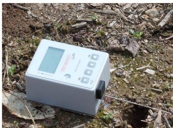
elettrodinamici (velocimetri) orientati N-S, E-W e verticalmente, alimentato da due batterie AA da 1,5 V, fornito di GPS interno e senza cavi esterni. I dati di rumore, amplificati e digitalizzati a 24 bit equivalenti, sono stati acquisiti alla frequenza di campionamento di 128 Hz.
