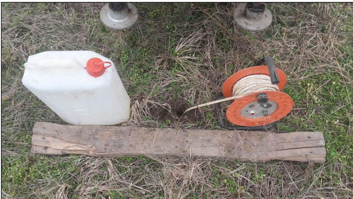
*Foto n°3: Prova di conducibilità idraulica K1 nel foro della prova DPSH 2*
