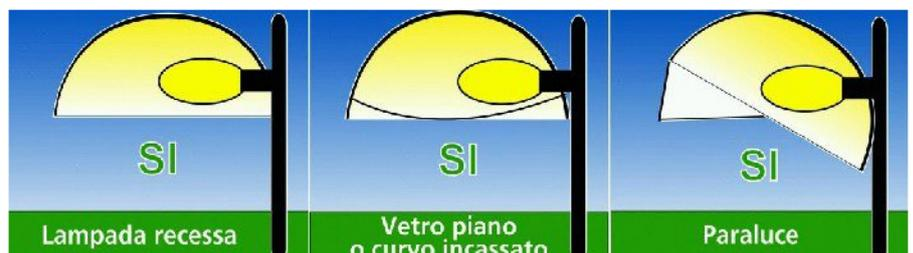
*Apparecchi conformi per configurazione alla Lr 17/2009*
