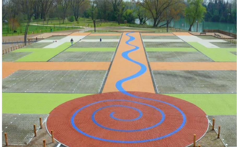
*Esempio realizzazione parcheggio mediante l'utilizzo di pavimentazioni drenanti*
